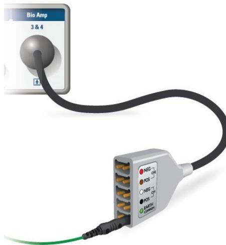
*Figura 2 Conexión del cable de tierra no apantallado.*
