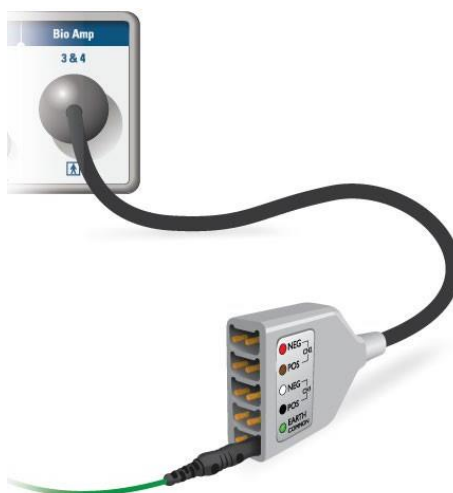
Figura 2: Conectando o cabo terra não blindado.
